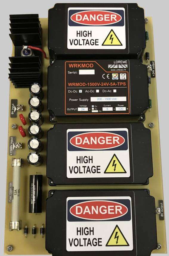
Convertisseur DC-DC régulé à très large plage d'entrée, qui présente l'avantage d'un rendement élevé, d'une haute fiabilité et d'une haute isolation de sécurité. Ce produit est destiné aux applications industrielles telles que la production d'énergie photovoltaïque.
